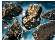
Bei der Verklammerung von Schotter mit Elastocoast® entsteht ein offenporiges Stützgerüst (schematische Darstellung).
